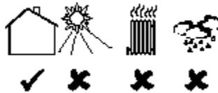
将冗余开关安置在一个洁净、通风好的地方。不要在要求的温度和湿度外运行冗余开关。
